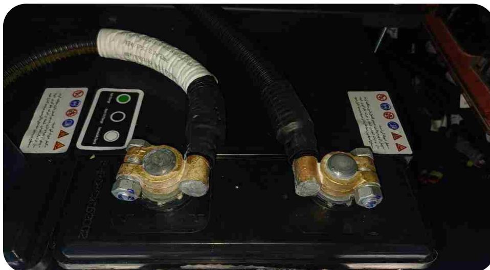
تصویر ۲۳: نحوه اتصال سرباطری‌ها
