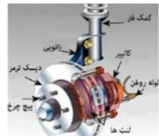
اجزای تشکیل دهنده ترمز دیسکی
