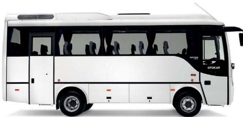
دارای دو در بادی یک لته در جلو و عقب برای سهولت در سوار و پیاده شدن
