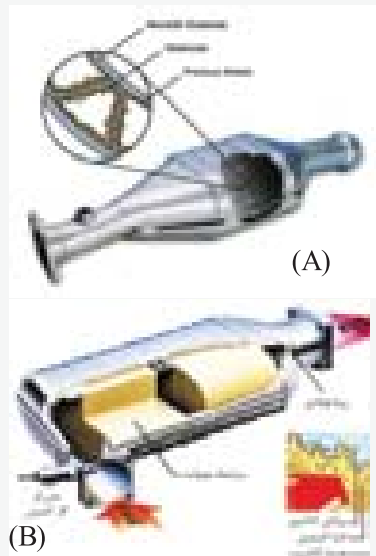
شکل ۲- مبدل‌های کاتالیستی؛ (A) فلزی و (B) سرامیکی
