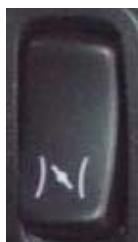
در اتوبوس‌های شهری عقاب - اسکانیا افزایش موقت دور موتور با استفاده از یک کلید تک حالت در کنار کلید مسترسوئیچ صورت می‌گیرد. در اتوبوس‌های شهری با شروع حرکت دور موتور کاهش یافته و در صورت توقف مجدد در صورت فعل بودن کلید، دور موتور مجددًا افزایش می‌یابد.
