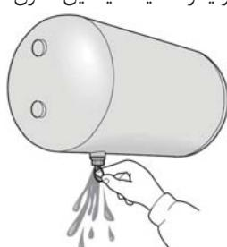
در صورت مشاهده آب یا روغن در هوا باید سایر مخازن نیز تخلیه شوند. وجود آب یا روغن در هوای فشرده ممکن است نشان دهنده آسیب‌دیدگی کمپرسور یا رطوبت‌گیر باشد.
