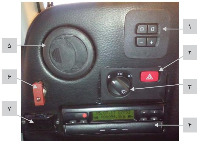
۱. مجموعه کلید تنظیم ساعت و روشنایی چراغ‌ها
