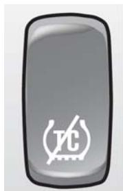
برای تغییر وضعیت به TC Off-road، سوئیچ را یک لحظه فشار دهید. سپس TC بکسوات چرخ را فقط با استفاده از ترمزها کنترل می‌کند و کاهش گشتاور موتور در حین بکسوات چرخ‌ها غیرفعال می‌شود. می‌توانید از TC Off-road هنگام رانندگی در گل، شن یا برف زیاد استفاده کنید. تذکر: چراغ مربوط به TC در دو حالت زیر روشن می‌شود:
