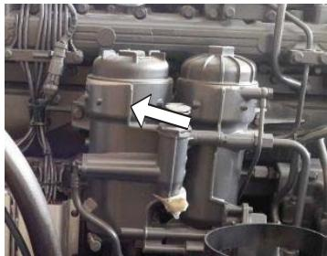
قسمت پائینی فیلتر جداکننده آب از سوخت از طلق ساخته شده است تا بتوان به راحتی تجمع آب و رسوبات را در ته آن مشاهده کرد.
